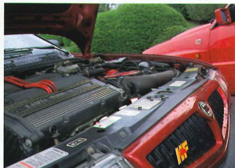
▲フィアット系 FIRE エンジンをベースとする HPE の 1995cc 直 4 D OHC ターボエンジン。最高出力 190ps / 最大トルク 29.6kg-m。
