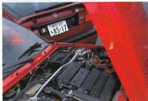
▲インテグラレのエンジンも、1995cc直4DOHCターボ(最高出力200ps/最大トルク31.0kg-m)だが、HPEとはまったく別物。
